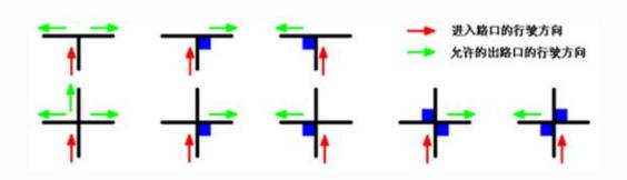
十字或丁字交叉处转弯标志: 机器 人在遇到转弯标志时应按图示正确 动作通过转弯标志。
