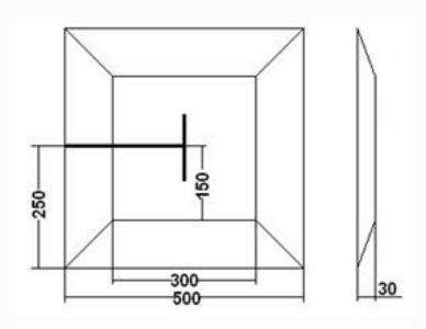
机器人待命区:长500mm、宽500mm的锥台,机器人要从待命区启动,完成任务后还要回到待命区。锥台上虽画有黑色引导线,但机器人可以从任何一边上下。
